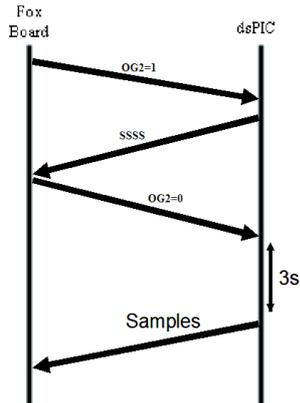
Fig. 3. Synchronization Handshake Protocol.
